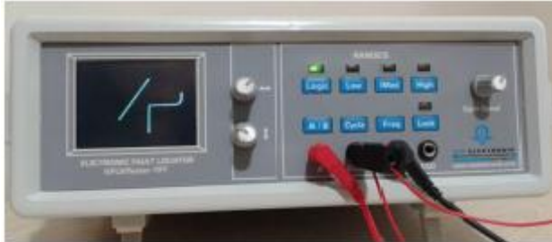
Şəkil 1. Empedans test cihazı (EFLVI Tester - TFT)
