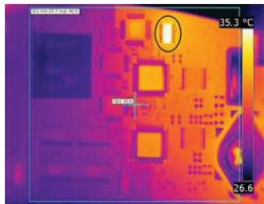
Şəkil 3. Elektron kartda çox isinən nasaz inteqral
